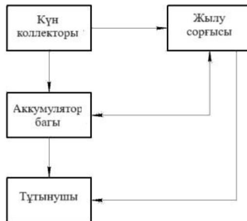
1.6 – сурет – Аралас (біріктірілген) қосылудың принципіалды сұлбасы
